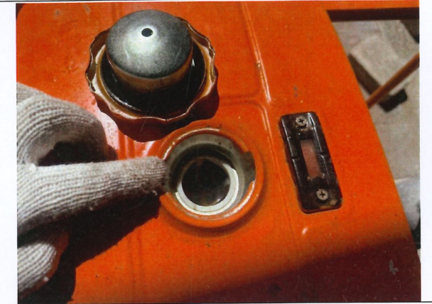
105-S029-02-燃油油位檢查
