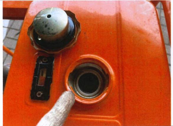
105-S029-02-燃油油位檢查
